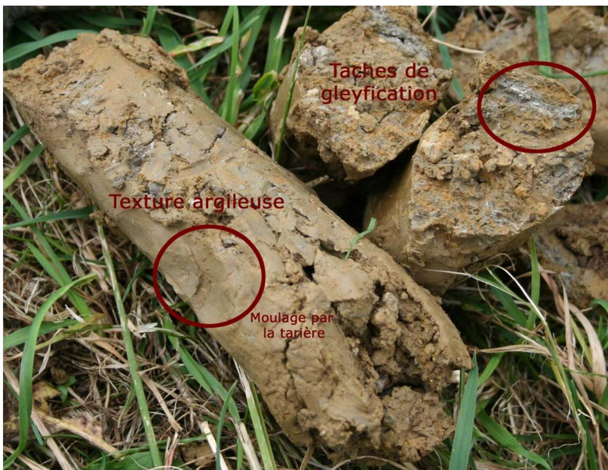
Figure 11 - Sol argileux à drainage naturel imparfait, inapte physiquement
