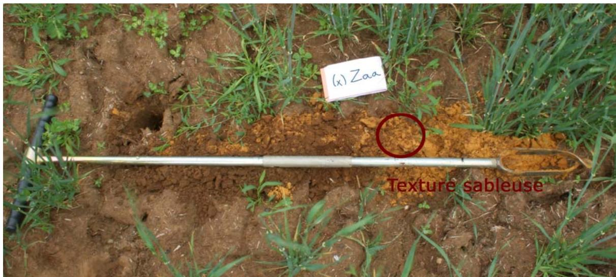
Figure 10 - Sol sableux à drainage naturel excessif, très bonne aptitude à la dispersion des eaux
