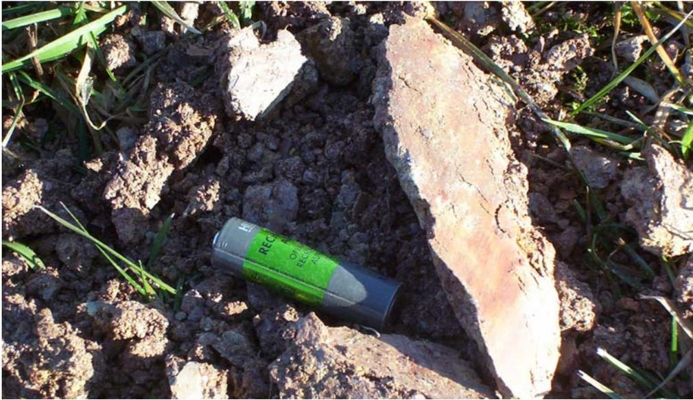
Figure 6 - Substrat schisto-phylladeux altéré
